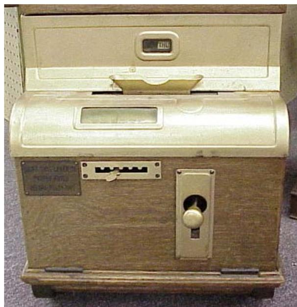
Abb. 9 Trichter eines Kartenapparates
