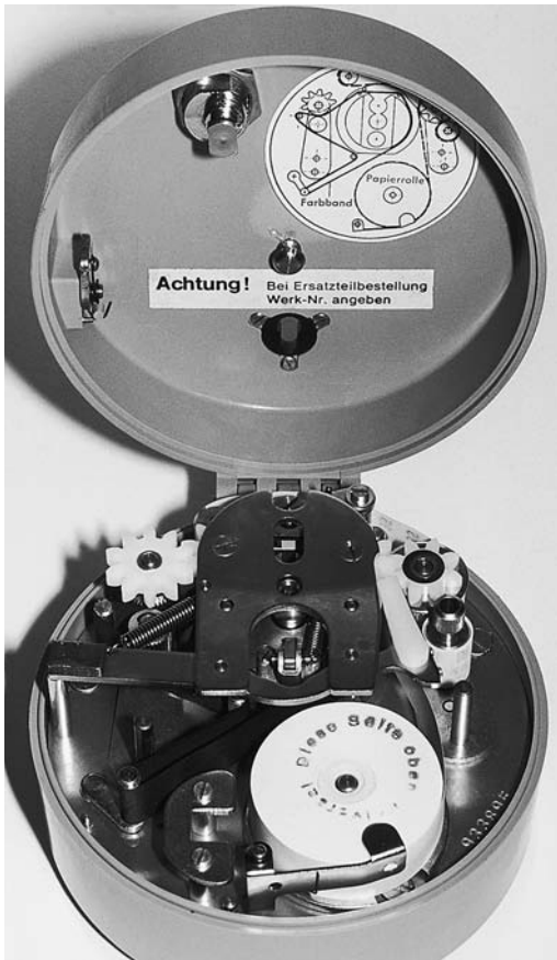
Abb. 11: Papierband-Wächteruhr Bürk Universal Nr. 50. Gehäuse von 1908 bis 1971 Aluminium, dann bis zur Fertigungseinstellung 1996 Kunststoff.
