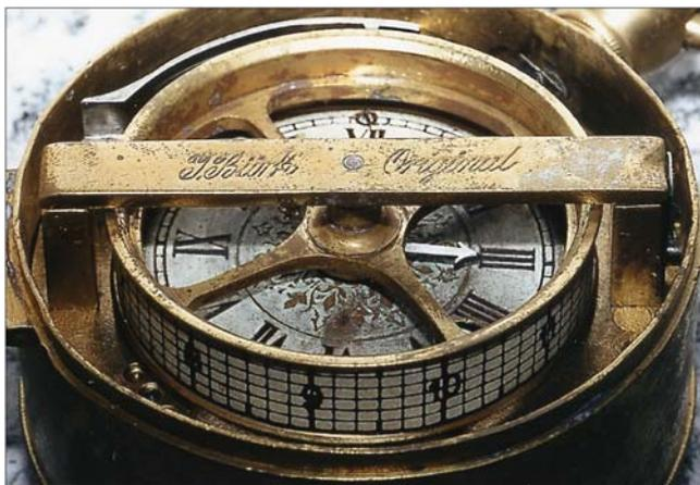
Trommel-Wächteruhr Bürk-Original nach dem Patent von 1855. Zum Auswechseln des Papierstreifens muss der Bügel hochgeklappt und die Papiertrommel herausgenommen werden. Ab ca. 1930 wurde die Trommel durch einen Rändelknopf fixiert. Dieses Modell wurde bis in die 1960er Jahre hergestellt.<sup>21,23</sup>
