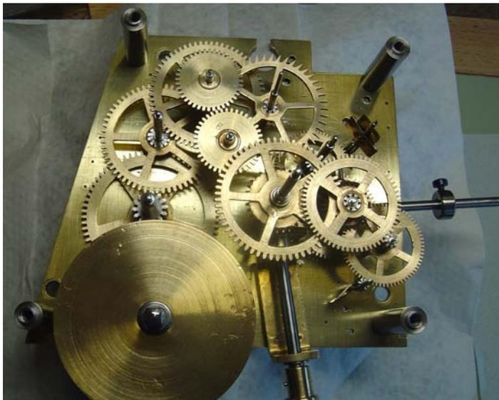
Das Gehwerk nach der Revision, das Federhaus und die nachfolgenden Räder sind nur für den Gang zuständig. Das Zentrumsrad, welches den Minutenzeiger trägt, und die mit ihm im Eingriff stehenden Räder (unter anderem auch ein Differential) sind für den Minutensprung zuständig und sind von den „Gangrädern“ getrennt. Das Hemmungsrad hat 45 Zähne und der Sekundenzeiger macht 90 Sprünge pro Minute, daher ist der Sekundenzeiger nur alle 2 Sekunden auf dem Index.
